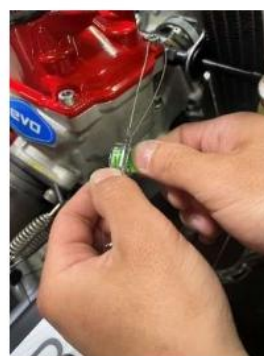
封印のハースを保持し、緑のつまみを時計回りに少しずつ回してワイヤーを巻いていってください。
