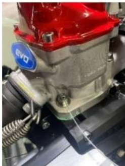
シリンダー→ヘッドカバーの順にワイヤーを通します。
