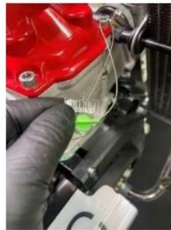
片側からワイヤーが出ている隣の穴にワイヤーの先を通します。
