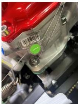
ワイヤーを巻ききると、緑つまみ部分が折れてワイヤーがロックされ、封印完了です。
