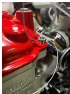
シリンダー→ヘッドカバーの順にワイヤーを通します。
