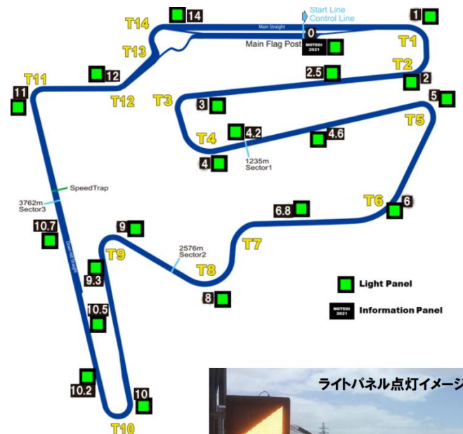
④ライトパネル設置箇所(資料 4 項)
