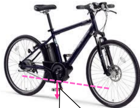
ステップは車軸より下に設けること
