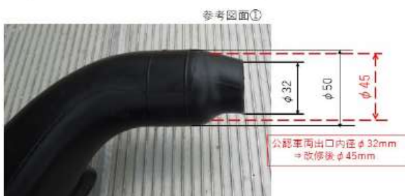
加工 ZX-25Rラムダクト外出口径変更寸法
