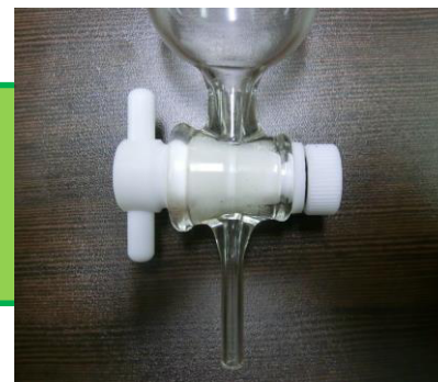
③燃料が流れる状態 ※車両取付け後の状態
