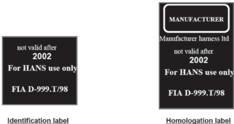
図 12: FHRシステム用として指定されたベルトのラベル表示例 FIA基準 8853/98、8854/98:
